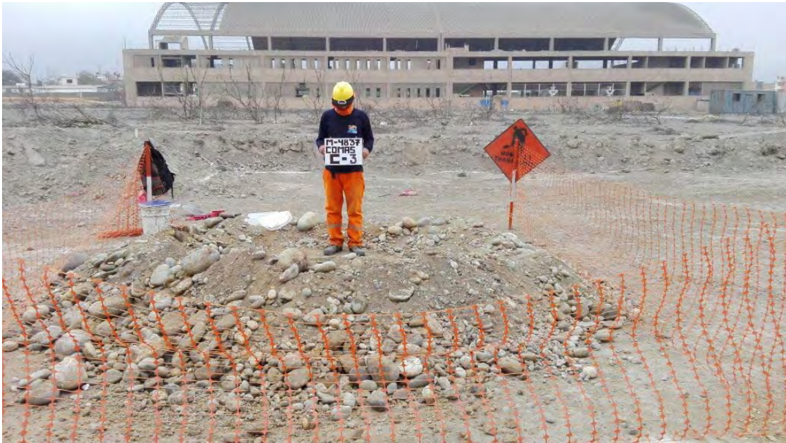
CALICATA C-3. SE APRECIA LA GRAVA ARENOSA EXTRAÍDA DE LA EXCAVACIÓN.
